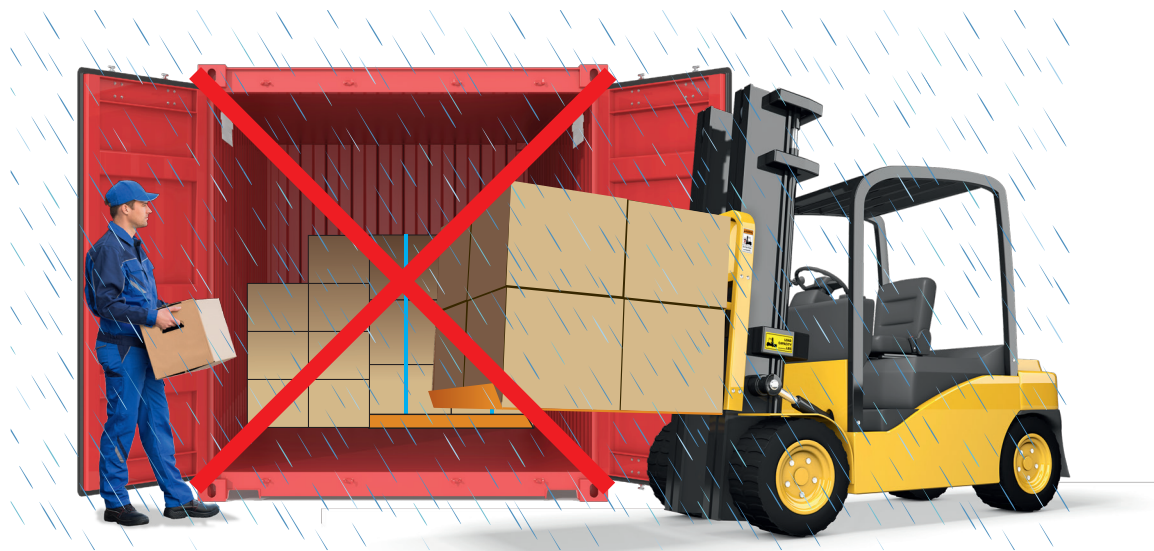
图 41：在潮湿/有水汽的条件下，请勿在室外装载集装箱。
