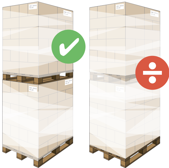
图 15：缠绕膜不得以任何方式妨碍托盘的搬运或存储操作。
